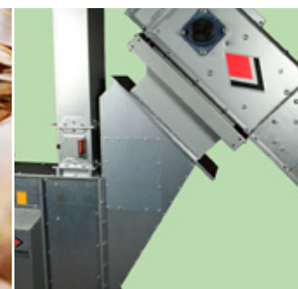
Anslutningskupa mellan transportör och elevator.
