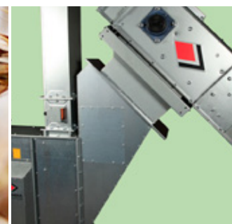
Anslutningskupa mellan transportör och elevator.
