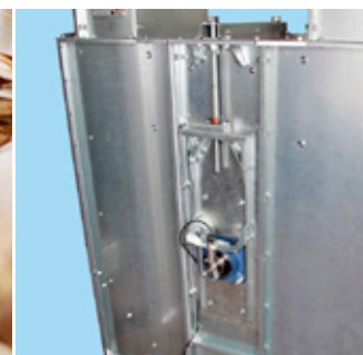
Remspänning i fot & varvtalsvakt.
