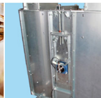
Remspänning i fot & varvtalsvakt.
